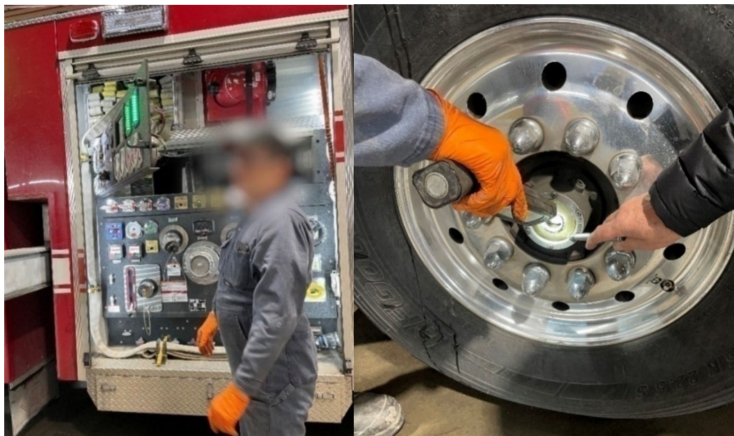
À gauche : Vérification du tableau de bord principal des équipements d'intervention incendie. À droite : Vérification du niveau de lubrifiant dans l'essieu.
