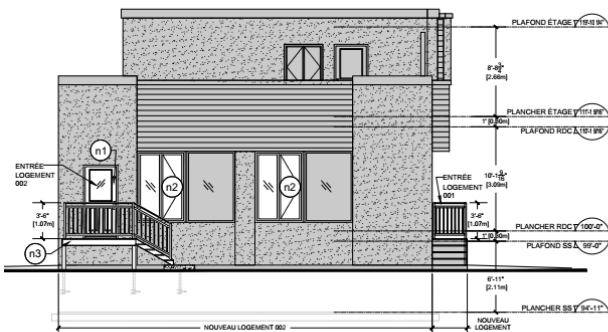
3 ÉLÉVATION FAÇADE ARRIÈRE PROPOSÉE ÉCHELLE 3/16" = 1'-0"
